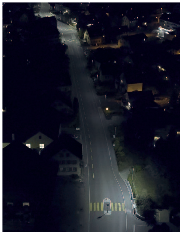
Abb. 39: Das verkehrsbeobachtende Licht in Urdorf (CH): Je nach Verkehrsaufkommen verändert sich die Beleuchtungsstärke zwischen 100 % (links) und 40 % (rechts)
